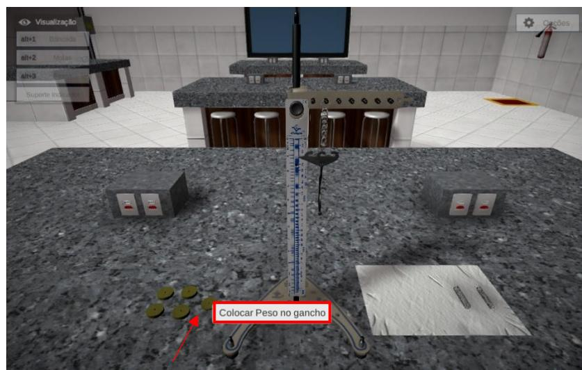
Observe que após o peso ser inserido no gancho, a mola sofre uma pequena deformação.
