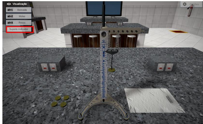
Observe na escala qual o valor dessa deformação inicial. Ela será necessária no cálculo da constante elástica.
