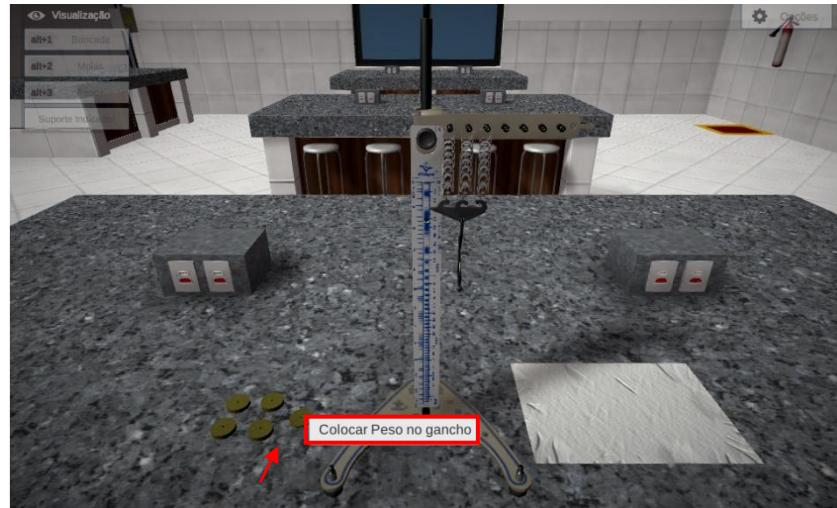
Observe que após o peso ser inserido no gancho, as molas sofreram uma pequena deformação.
