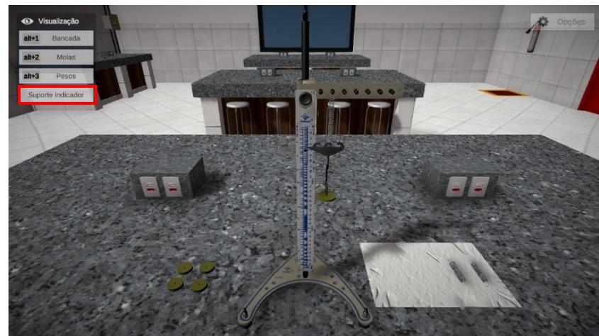
Observe na escala qual o valor dessa deformação inicial. Ela será necessária no cálculo da constante elástica.
